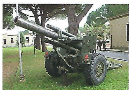
Obice da 155/23 a traino meccanico: gittata massima 15.000 metri.
